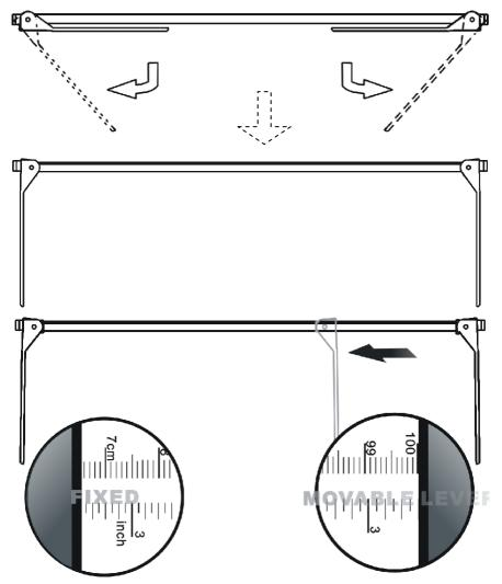
Rango de medición entre 100 y 1000 mm. Presione el tope del cabezal para medir la altura.
