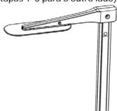
4. Instale a haste de altura + batente de cabeça no suporte usando parafusos Philips
