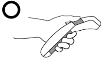
Richtig Hand Elektrode Kontakt
