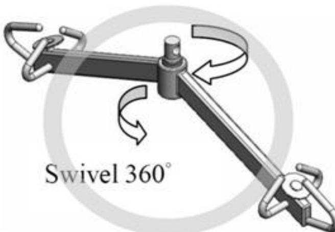
Même si les balances élévatrices MHS2510I / MHS 2 610I avec joints à cardan à rotation horizontale sont utilisées, la rotation doit être effectuée par le système de levage du patient et non par la balance élévatrice, afin de minimiser le risque d'endommagement de la balance élévatrice.
