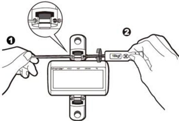
**IMPORTANT : la vis Nylock doit être fixée des deux côtés (un côté avec un tournevis, l'autre côté avec une clé dynamométrique). La vis Nylock ne se serrera pas et tournera simplement sur place si aucune contre-force de l'autre côté n'est appliquée.**
