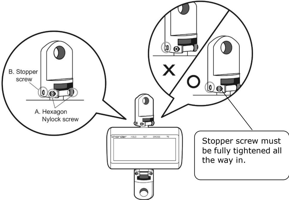
**ATTENTION : N'utilisez PAS la balance élévatrice si des vis sont desserrées.**
