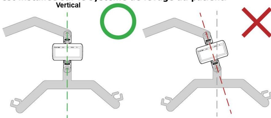
Si la balance élévatrice est inclinée et pas complètement verticale lors de son installation, cela entraînera la flexion des joints de la balance élévatrice. Cela finira par provoquer une rupture une fois utilisée suffisamment de fois et soumise à un poids suffisant, car une force est appliquée contre les joints d'une manière qu'ils ne sont pas conçus pour supporter.
