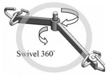
se utilizan las básculas elevadoras MHS2510I / MHS 2 610I con juntas cardán giratorias horizontales, la rotación debe ser realizada por el sistema de elevación de pacientes, y no por la báscula elevadora, para minimizar el riesgo de daños a la báscula elevadora.
