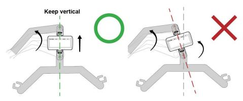
Incluso si la báscula elevadora está completamente vertical cuando está instalada, si se dobla en cualquier punto durante el funcionamiento (por ejemplo: el sistema de elevación de pacientes eleva al paciente a punto más alto para la medición del peso), se aplica el mismo riesgo de rotura.
