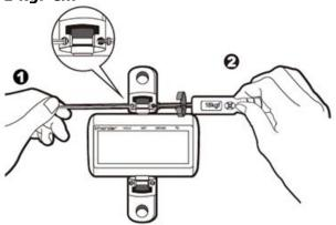
IMPORTANTE: El tornillo Nylock debe asegurarse desde ambos lados (un lado con un destornillador y el otro lado con una llave dinamométrica). El tornillo Nylock no se ajustará y simplemente girará en su lugar si no se aplica una fuerza contraria desde el otro lado.
