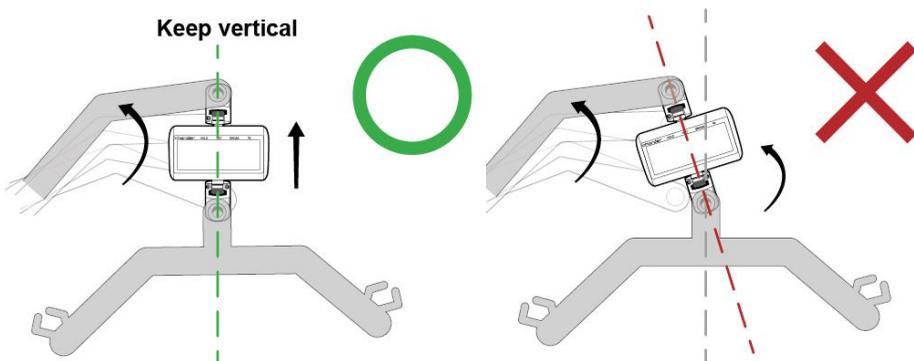
Mesmo que a balança de elevação esteja completamente vertical quando instalada, se ela for dobrada em qualquer ponto da operação (ex.: o sistema de elevação do paciente eleva o paciente para ponto mais alto para medição de peso), o mesmo risco de quebra se aplica.
