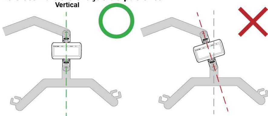
Se a Lift Scale estiver inclinada e não completamente vertical quando instalada, isso fará com que as juntas da Lift Scale dobrem. Isso acabará causando quebra quando usada vezes suficientes e submetida a peso suficiente, porque a força está sendo aplicada contra as juntas de uma forma que elas não foram projetadas para suportar.
