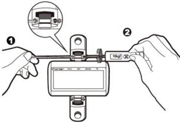
**IMPORTANT : la vis Nylock doit être fixée des deux côtés (un côté avec un tournevis, l'autre côté avec une clé dynamométrique). La vis Nylock ne se serrera pas et tournera simplement en place si aucune contre-force de l'autre côté n'est appliquée.**
