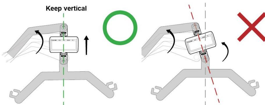
Incluso si Lift Scale está completamente vertical cuando está instalado, si se dobla en cualquier punto durante el funcionamiento (por ejemplo: el sistema de elevación de pacientes eleva al paciente a un punto más alto para medir su peso), se aplica el mismo riesgo
