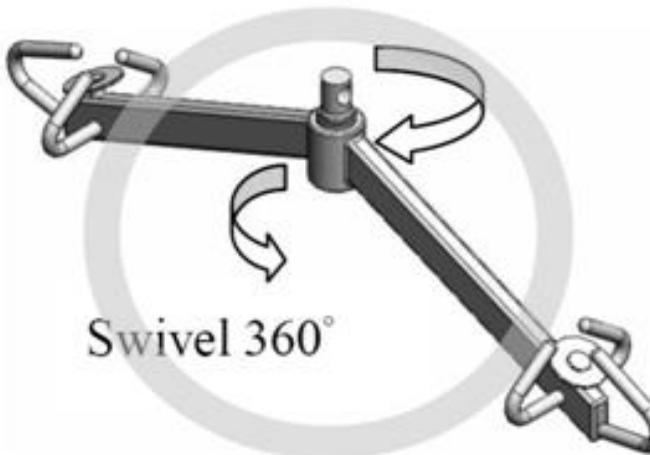
se utilizan las básculas elevadoras MHS2510I / MHS 2 610I con juntas cardán giratorias horizontales, la rotación debe ser realizada por el sistema de elevación de pacientes, y no por la báscula elevadora, para minimizar el riesgo de daños a la báscula elevadora.
