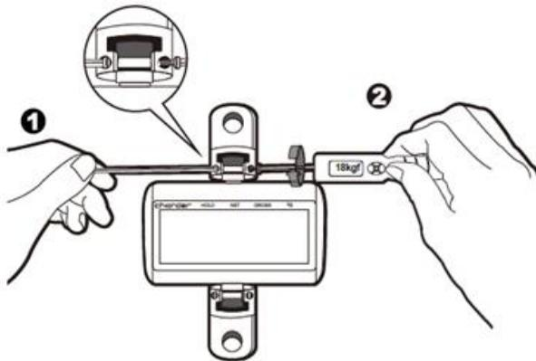
**IMPORTANTE: O parafuso Nylock deve ser fixado de ambos os lados (um lado com chave de fenda, o outro lado com chave de torque). O parafuso Nylock não apertará e simplesmente girará no lugar se a contraforça do outro lado não for aplicada.**
