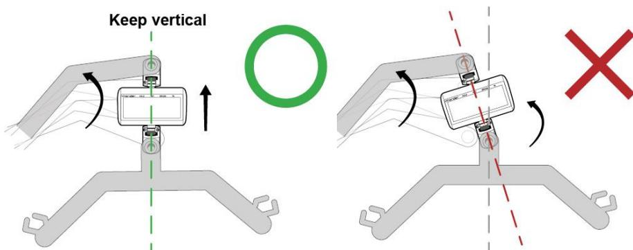
Mesmo que a balança de elevação esteja completamente vertical quando instalada, se ela for dobrada em qualquer ponto da operação (por exemplo: o sistema de elevação do paciente eleva o paciente a um ponto mais alto para medição do peso), o mesmo
