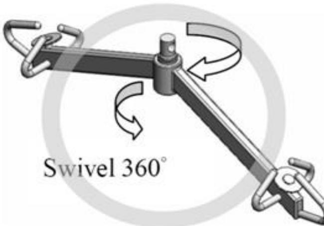
Mesmo se forem utilizadas as balanças elevatórias MHS2510I / MHS2610I com juntas cardan rotativas horizontais, a rotação deve ser realizada pelo sistema de elevação do paciente, e não pela balança elevatória, para minimizar o risco de danos à balança elevatória.
