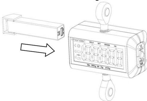
Quando a energia estiver baixa, recarregue a bateria usando a porta micro-USB. Quando a luz da porta estiver piscando **em vermelho**, a bateria está sendo carregada. Quando a luz da porta estiver estável **em verde**, a bateria está totalmente carregada.
