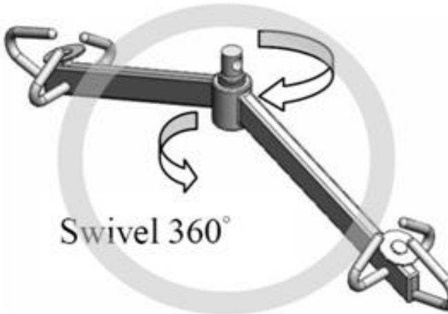
Auch wenn die Liftwaagen MHS2510I / MHS2610I / MHS2710 mit horizontal rotierenden Kardangelenken verwendet werden, sollte die Rotation durch das Patientenliftsystem und nicht durch die Liftwaage erfolgen, um das Risiko einer Beschädigung der Liftwaage zu minimieren.
