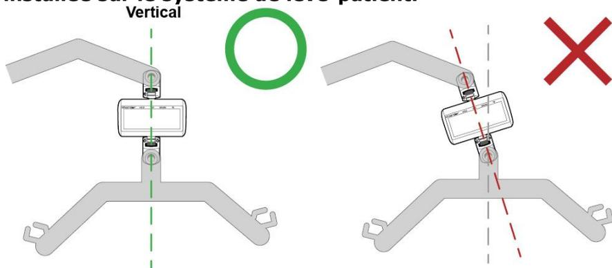
Si la balance de levage est inclinée et n'est pas complètement verticale une fois installée, les joints de la balance de levage se plieront. Cela finira par provoquer une rupture une fois utilisé suffisamment de fois et soumis à un poids suffisant, car la force est appliquée contre les joints d'une manière qui ils ne sont pas conçus pour gérer.
