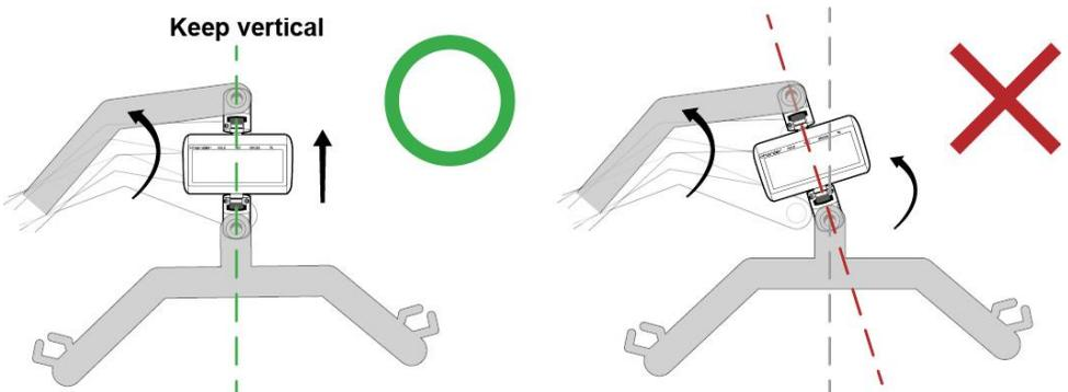
Incluso si Lift Scale está completamente vertical cuando está instalado, si se dobla en cualquier punto durante el funcionamiento (por ejemplo: el sistema de elevación de pacientes eleva al paciente a un punto más
