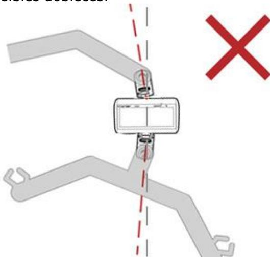
Si observa algún daño visual o deformación, NO utilice la báscula elevadora.
