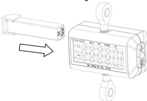
Cuando la batería esté baja, recargue la batería mediante el puerto micro-USB. Cuando la luz del puerto parpadee **en rojo** , la batería se estará cargando. Cuando la luz del puerto esté **verde estable** , la batería estará completamente cargada.
