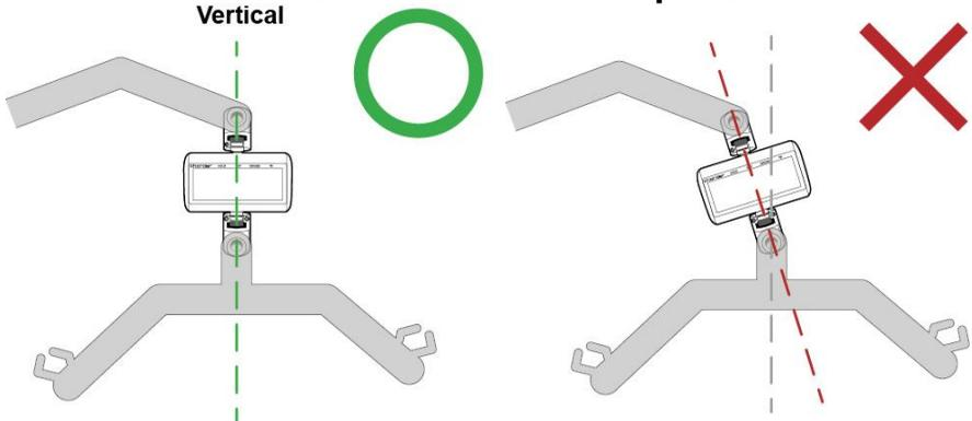
Si la báscula elevadora está inclinada y no completamente vertical al instalarla, esto hará que las juntas de la báscula elevadora se doblen. Esto eventualmente provocará roturas una vez que se use varias veces y se someta a suficiente peso, porque se está aplicando fuerza contra las juntas de una manera que no están diseñadas para soportar.
