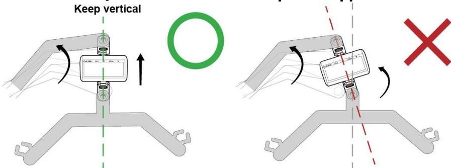
Auch wenn die Liftwaage bei der Installation vollkommen vertikal ist, besteht das gleiche Bruchrisiko, wenn sie während des Betriebs an irgendeiner Stelle verbogen wird (z. B.: Das Patientenliftsystem hebt den Patienten zur Gewichtsmessung an einen höheren Punkt).
