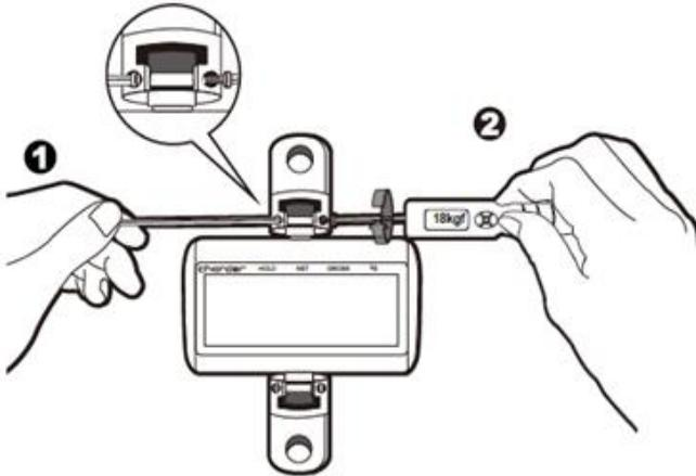
**WICHTIG: Die Nylock- Schraube muss von beiden Seiten gesichert werden (eine Seite mit Schraubendreher, die andere Seite mit Drehmomentschlüssel). Die Nylock -Schraube lässt sich nicht festziehen und dreht sich einfach an Ort und Stelle, wenn keine Gegenkraft von der anderen Seite ausgeübt wird.**
