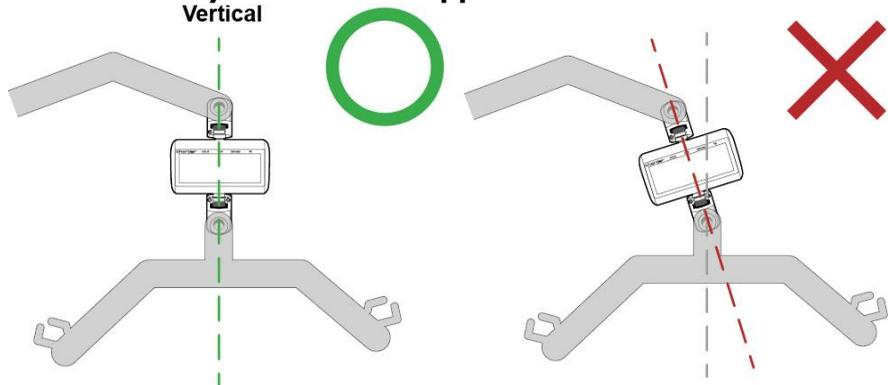
Wenn die Lift Scale bei der Installation geneigt und nicht vollständig vertikal ist, verbiegen sich die Gelenke der Lift Scale. Dies führt schließlich zum Bruch, wenn die Waage oft genug verwendet und ausreichendem Gewicht ausgesetzt wird, da auf die Gelenke eine Kraft ausgeübt wird, für die sie nicht ausgelegt sind.
