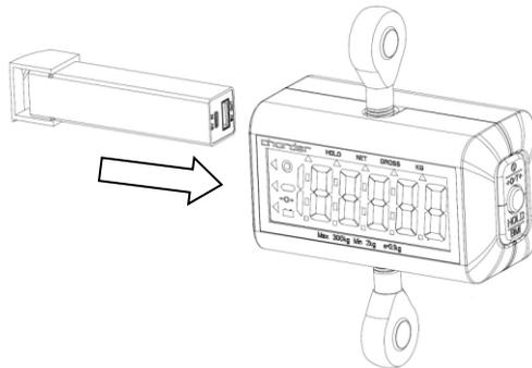
Wenn der Akku schwach ist, laden Sie ihn bitte über den Micro-USB-Anschluss auf. Wenn die Anschlussleuchte **rot blinkt**, wird der Akku geladen. Wenn die Anschlussleuchte dauerhaft **grün leuchtet**, ist der Akku vollständig geladen.
