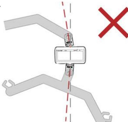
**2. Si aucun dommage visuel n'est observé, la balance élévatrice doit être tournée manuellement pour tester si un mouvement incorrect est possible.**
