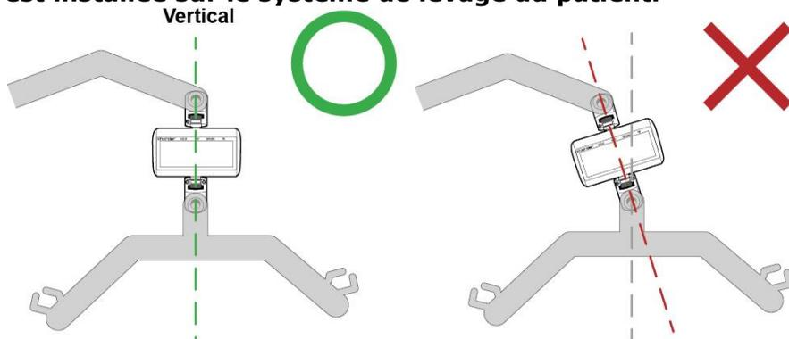
Si la balance élévatrice est inclinée et pas complètement verticale lors de son installation, les joints de la balance élévatrice se plieront. Cela finira par provoquer une rupture une fois utilisée suffisamment de fois et soumise à un poids suffisant, car une force est appliquée contre les joints d'une manière qu'ils ne sont pas conçus pour supporter.
