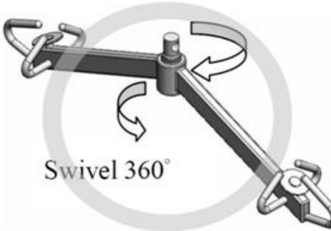
Même si les balances élévatrices MHS2510I / MHS2610I / MHS2710 avec joints à cardan à rotation horizontale sont utilisées, la rotation doit être effectuée par le système de levage du patient et non par la balance élévatrice, afin de minimiser le risque d'endommagement de la balance élévatrice.
