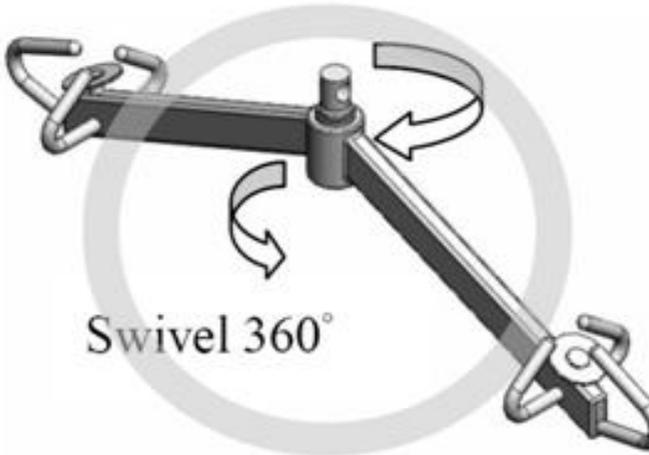
Incluso si se utilizan las básculas elevadoras MHS2510I / MHS2610I / MHS2710 con juntas cardán giratorias horizontales, la rotación debe ser realizada por el sistema de elevación de pacientes, y no por la báscula elevadora, para minimizar el riesgo de daños a la báscula elevadora.
