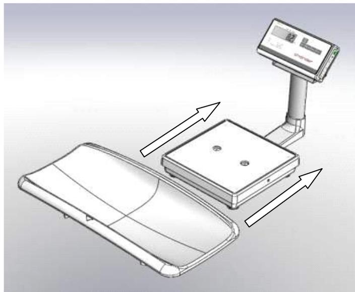
3. Deslice la bandeja sobre la plataforma de medición (vista inversa)
