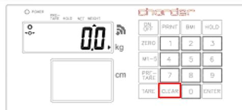
NOTA: El peso de pre-tara debe ser menor a la capacidad máxima, de lo contrario la pantalla mostrará 0,00 después de presionar la tecla [ **ENTER** ] y el operador tendrá que volver a ingresar la configuración de pre-tara.
