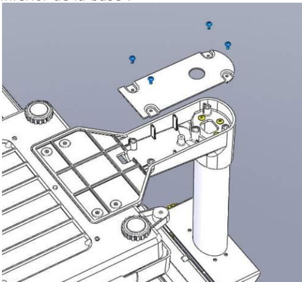
3. Inserte el pie ajustable en el panel de la base. Gírelo en sentido contrario a las agujas del reloj para extenderlo y en sentido horario para retraerlo.
