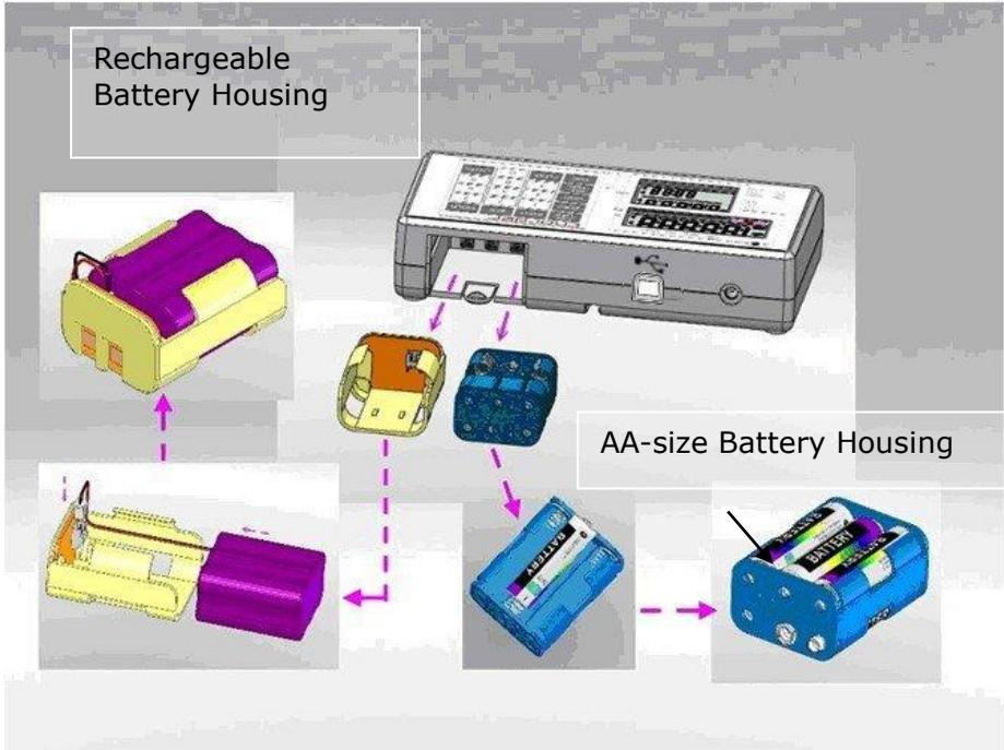
5. Instale la carcasa de la batería en el compartimento y asegúrese de que el lado derecho del pasador de la carcasa esté orientado hacia el interior de la posición de conexión.
