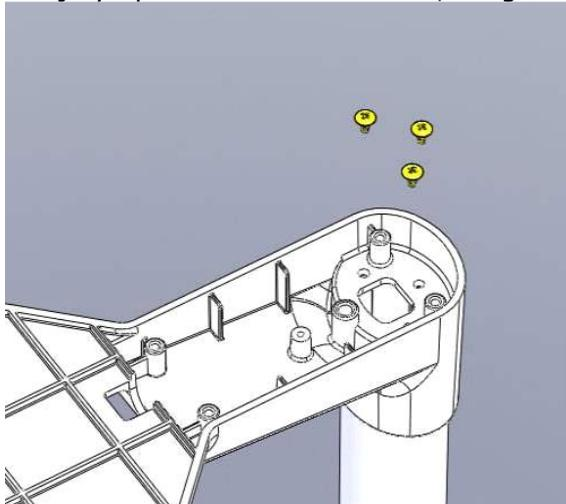
2. Ajuste y apriete los cuatro tornillos para asegurar el panel en la parte inferior de la base .
