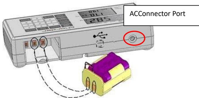
Si Lo aparece un mensaje en la pantalla LCD, cargue la batería rápidamente para evitar dañarla.
