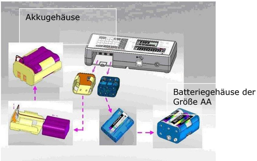
5. Setzen Sie das Batteriegehäuse in das Fach ein und achten Sie darauf, dass die rechte Seite des Gehäusestifts in Richtung der Innenseite der Anschlussposition zeigt.
