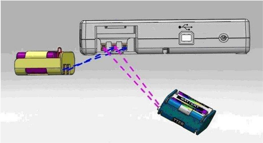
6. Schieben Sie die Abdeckung zurück, um das Batteriefach zu schließen. Schalten Sie das Gerät ein, um zu bestätigen, dass die Batterie richtig eingesetzt ist.
