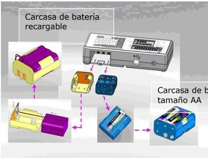
5. Instale la carcasa de la batería en el compartimiento y asegúrese de que el lado derecho del pasador de la carcasa esté orientado hacia el interior de la posición de conexión.
