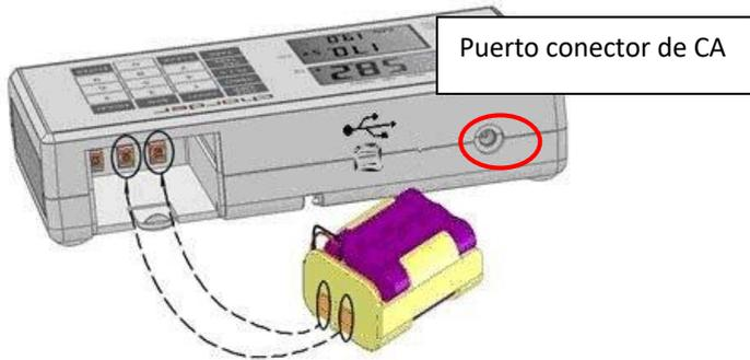
Si **Lo** aparece un mensaje en la pantalla LCD, cargue la batería rápidamente para evitar dañarla.
