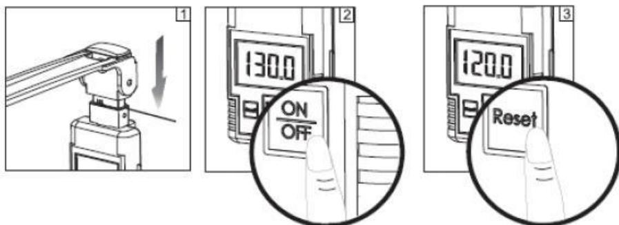
Deslice la varilla de medición hacia abajo por completo. Encienda el HM200D con la tecla **[ON/OFF]** . Si la altura que se muestra no es "120 cm", presione la tecla **[Reset]** para calibrar a 120 cm.
