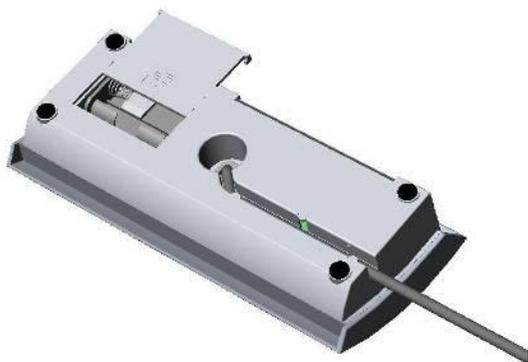
2. Desconecte o cabo da bateria recarregável do conector no compartimento da bateria
