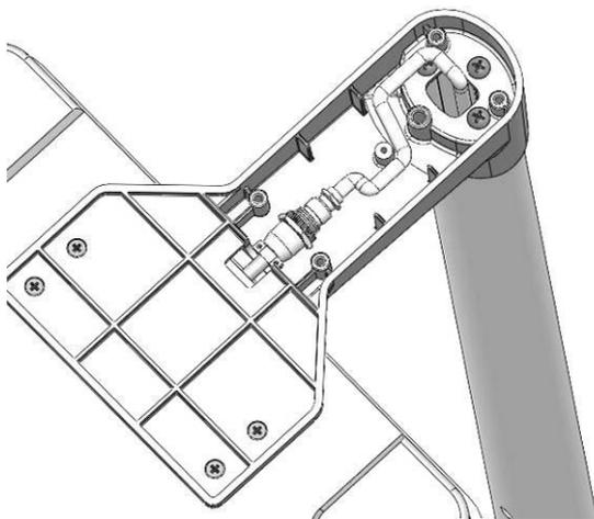
4. Fixez le couvercle inférieur et fixez-le à l'aide de quatre vis M4\*0,7\*8
