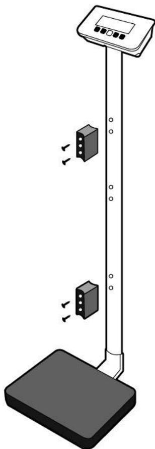
1. Fixez deux blocs de fixation à la colonne à l'aide de quatre vis à tête plate
