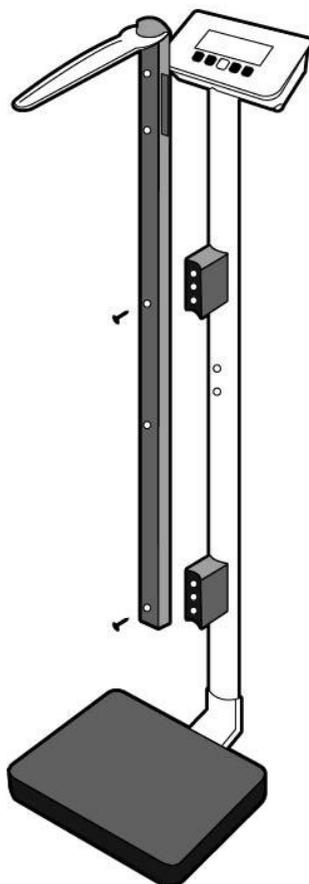
2. Fixez la tige de hauteur aux blocs à l'aide de deux vis à tête plate
