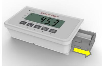
3. Coloque las pilas en el compartimento (asegúrese de que la polaridad sea correcta)
