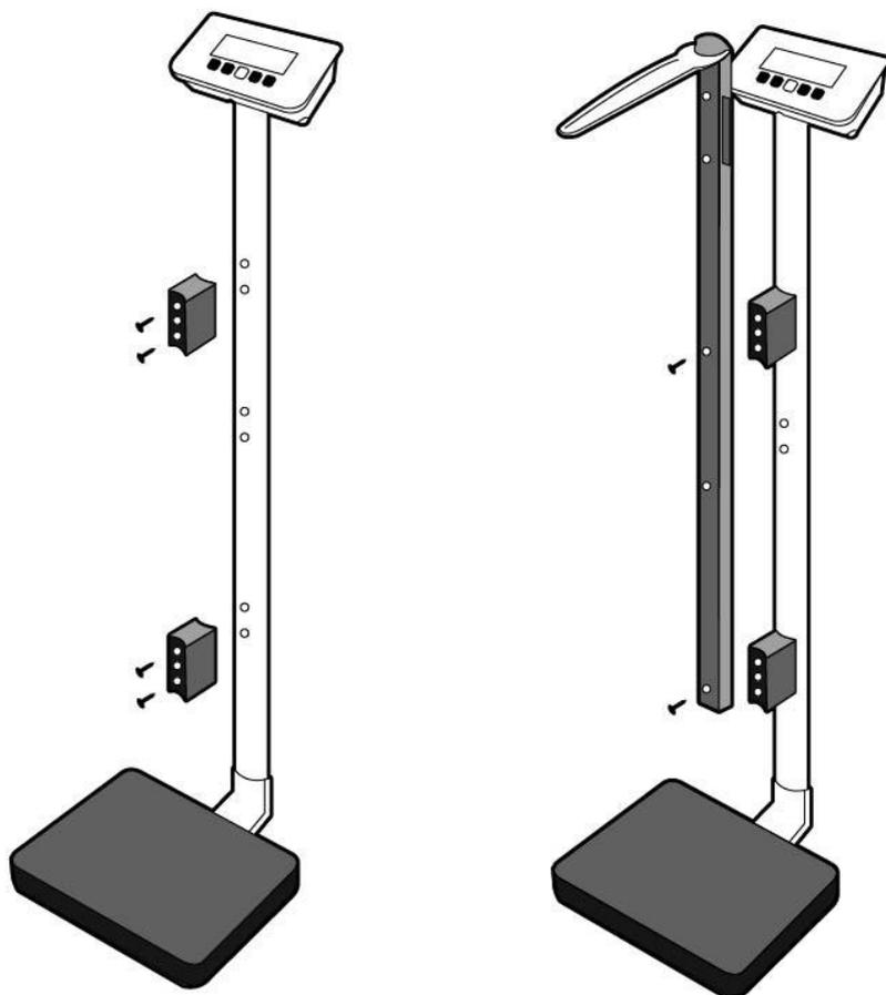
1. Fije dos bloques de fijación a la columna utilizando cuatro tornillos de cabeza plana.
