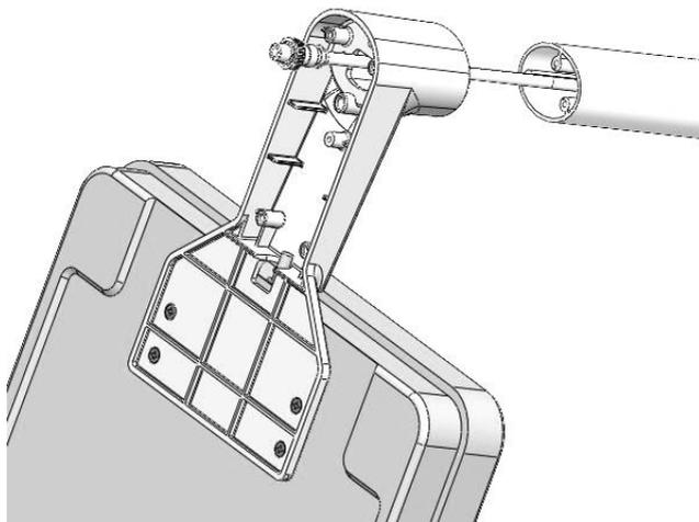
2. Asegure la columna con tres tornillos M4\*0,7\*15
