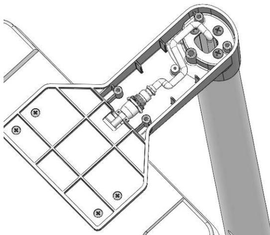
4. Coloque la cubierta inferior y fíjela con cuatro tornillos M4\*0,7\*8
