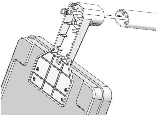
2. Fixe a coluna usando três parafusos M4\*0,7\*15
