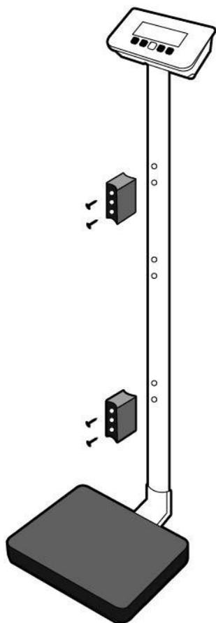
1. Fixe dois blocos de fixação à coluna usando quatro parafusos de cabeça chata
