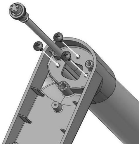
3. Passe o cabo ao longo da abertura no assento da coluna
