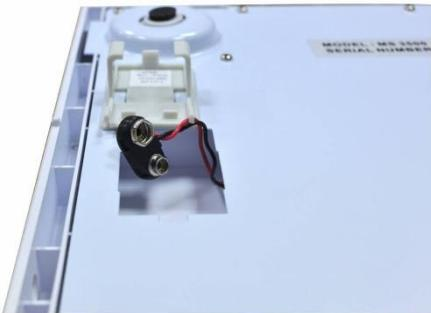
4. Schließen Sie die 9V-Batterie an den Anschluss an
