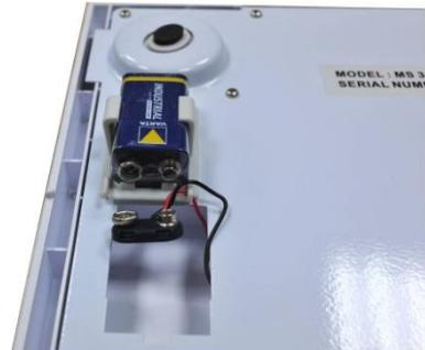
5. Legen Sie die Batterie in das Gehäuse. Schließen Sie die Abdeckung und drehen Sie die Waage wieder um. Schalten Sie das Gerät ein, um zu prüfen, ob die Batterien richtig eingelegt sind.
