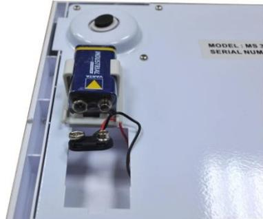
5. Placez la pile dans le boîtier. Fermez le couvercle et retournez la balance. Allumez l'appareil pour vérifier si les piles sont correctement installées.
