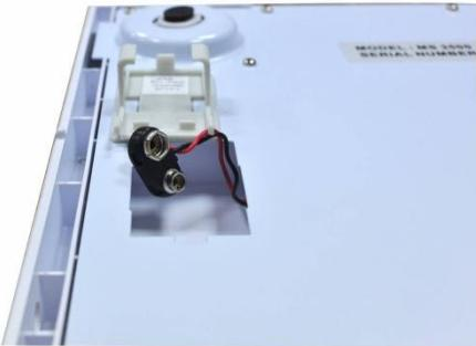
4. Connectez la batterie 9 V au connecteur
