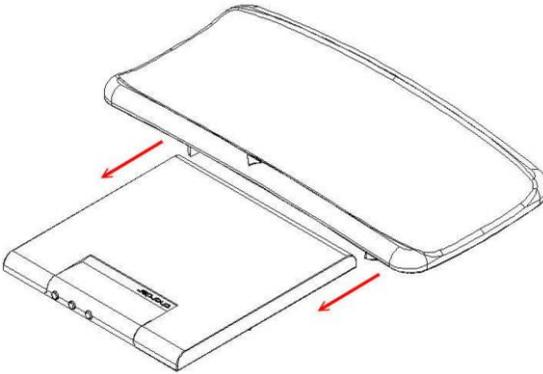
2. Dé vuelta el dispositivo. Fije la bandeja al dispositivo girando la perilla a cada lado de la bandeja (gire en el sentido de las agujas del reloj para apretar, gire en el sentido contrario de las agujas del reloj para aflojar).
