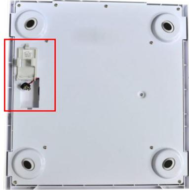
3. El dispositivo utiliza una batería de 9 V.
