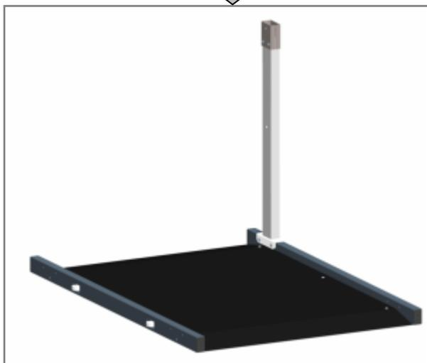
2. Assemblez le poteau sur la plate-forme en utilisant la même procédure que l'étape 1.
