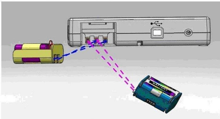
6. Deslize a tampa para trás para fechar o compartimento da caixa da bateria. Ligue a energia para confirmar que a bateria está corretamente instalada.
