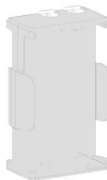
(Fig. 2. Caixa da bateria vazia)
