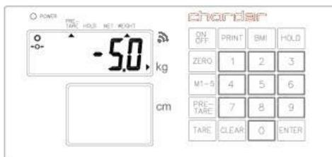
Appuyez sur **[Effacer]** pour revenir au mode normal et effectuer la nouvelle pesée suivante.
