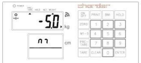
Presione los dígitos de la tecla numérica **1 ~ 5** para asignar hasta 5 memorias de valores de pre-tara para el próximo pesaje de peso real .
