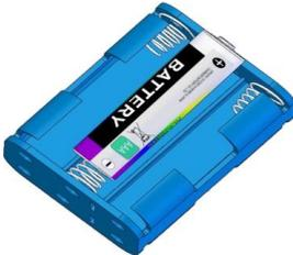
4. Achten Sie beim Einsetzen des Batteriegehäuses auf den korrekten Kontakt mit den Gehäusestiften.
