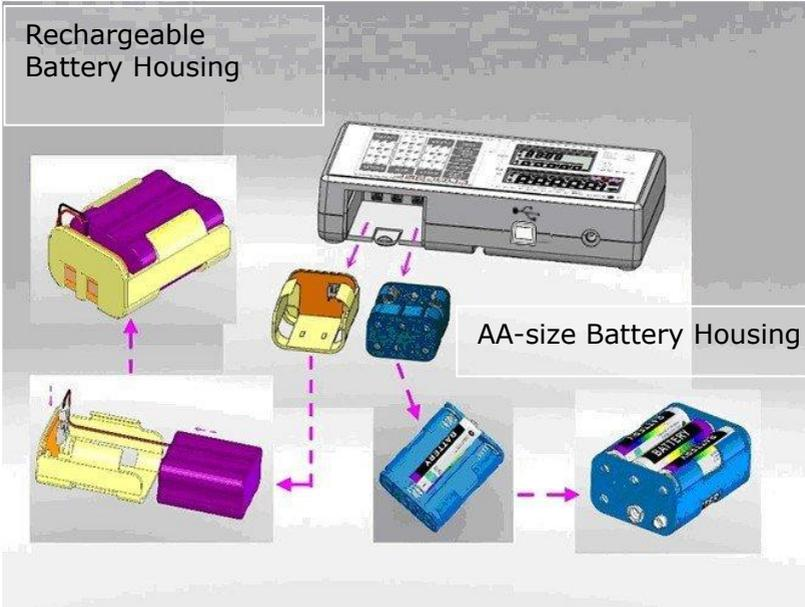
5. Installez le boîtier de la batterie dans le compartiment et assurez-vous que le côté droit de la broche du boîtier est orienté vers l'intérieur de la position de connexion.
