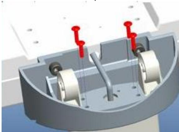
2. Assurez-vous que les quatre pieds réglables et le pied de stabilisation sont au même niveau avant d'utiliser l'appareil. Tournez dans le sens inverse des aiguilles d'une montre pour l'étendre, dans le sens des aiguilles d'une montre pour le rétracter
