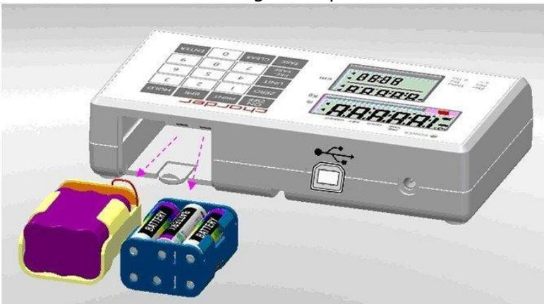
4. Asegúrese de que las baterías estén instaladas correctamente en la carcasa.
