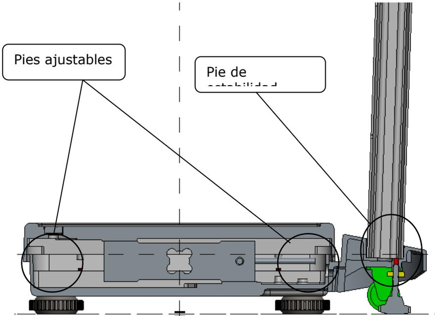
3. Retraiga el pie de estabilidad antes de mover el dispositivo usando ruedas giratorias.
