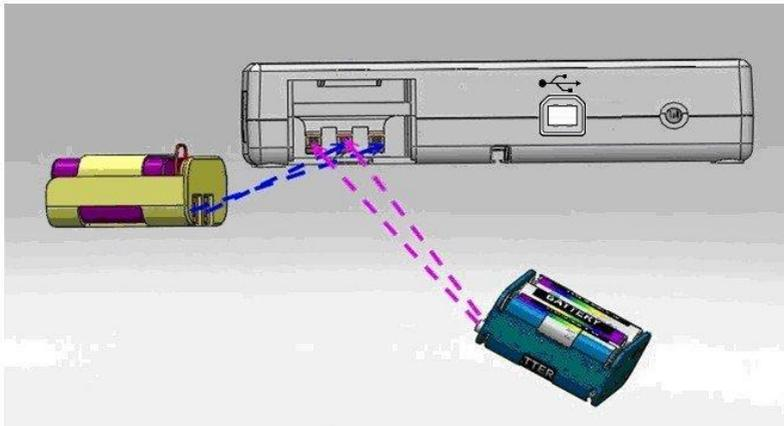
6. Deslice la tapa hacia atrás para cerrar el compartimento de la batería. Encienda el dispositivo para confirmar que la batería esté instalada correctamente.
