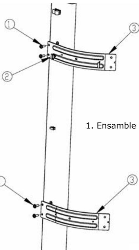
1. Ensamble dos soportes en la columna.
