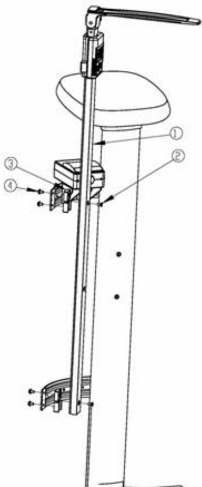
2. Coloque la varilla de altura en el soporte y apriete los tornillos.
