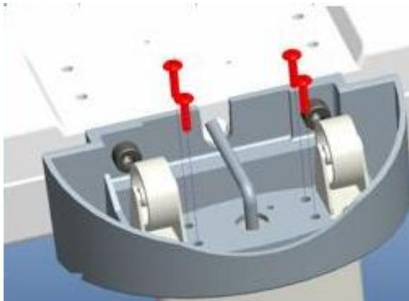
2. Asegúrese de que los cuatro pies ajustables y el pie de estabilidad estén al mismo nivel antes de usar el dispositivo. Gírelo en sentido contrario a las agujas del reloj para extenderlo y en sentido horario para retraerlo.
