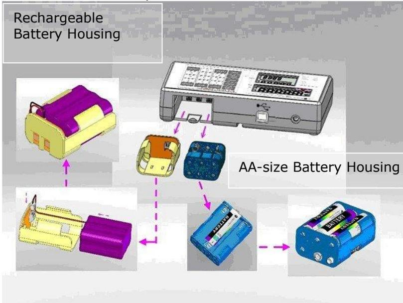
5. Instale o compartimento da bateria no compartimento e certifique-se de que o lado direito do pino do compartimento esteja voltado para dentro da posição de conexão.
