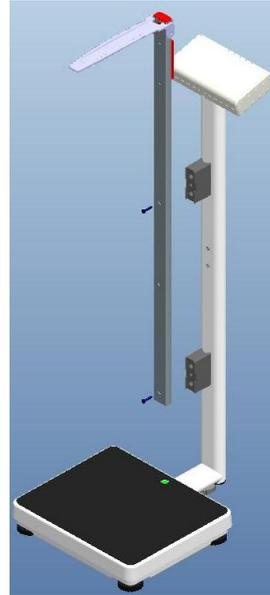
Etapa 2. Fixe a haste de altura aos blocos usando dois parafusos de cabeça chata
