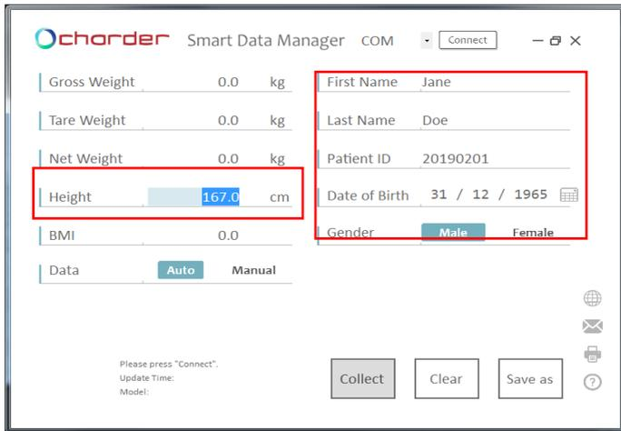
2. Realizar medição. Se **[Auto]** for selecionado, os resultados serão transmitidos do dispositivo para o software automaticamente e exibidos no lado esquerdo da tela. Se **[Manual]** for selecionado, o usuário deve pressionar "Collect".
