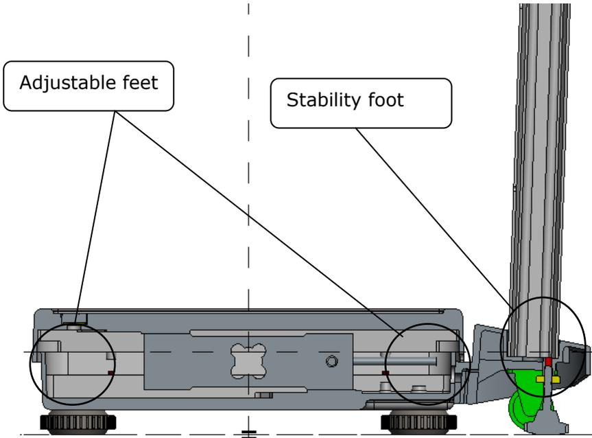
3. Retraia o pé de estabilidade antes de mover o dispositivo usando rodas giratórias
