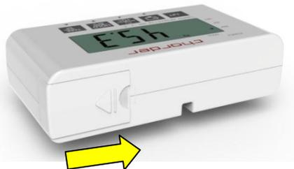
6. Mettez l'appareil sous tension pour vérifier que la batterie est correctement installée.
