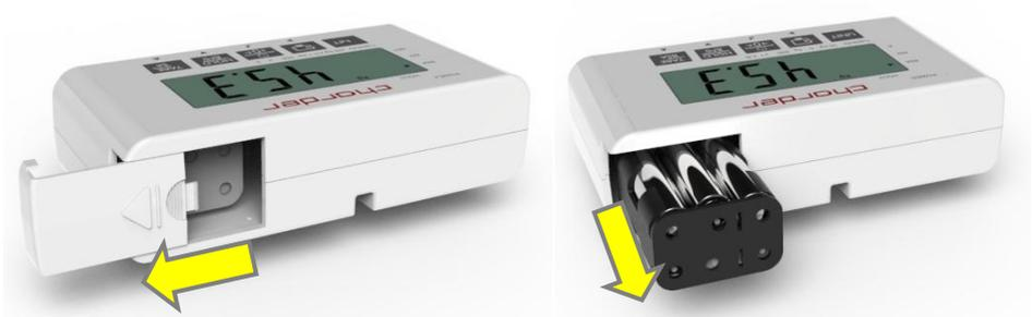
3. Coloque las pilas en el compartimento (asegúrese de que la polaridad sea correcta)
