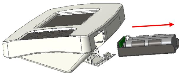
3. Coloque a nova bateria no compartimento e insira no indicador
