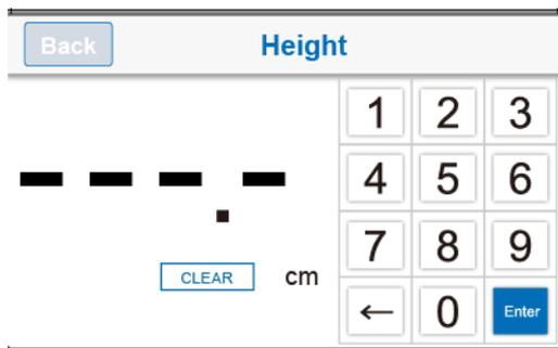
2. Insira a altura usando as teclas numéricas (ex.: para inserir 170 cm , pressione 1-7-0-0 ). Pressione a tecla **[CLEAR]** para inserir novamente.
