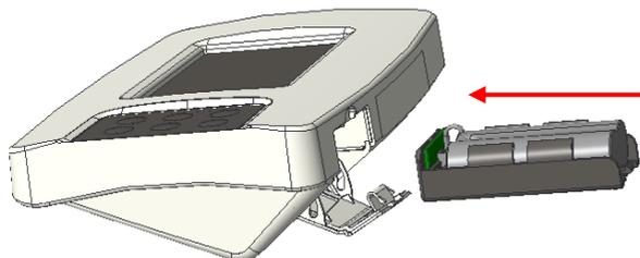
4. Feche a tampa do compartimento da bateria . Ligue a energia para confirmar se a bateria está instalada corretamente.
