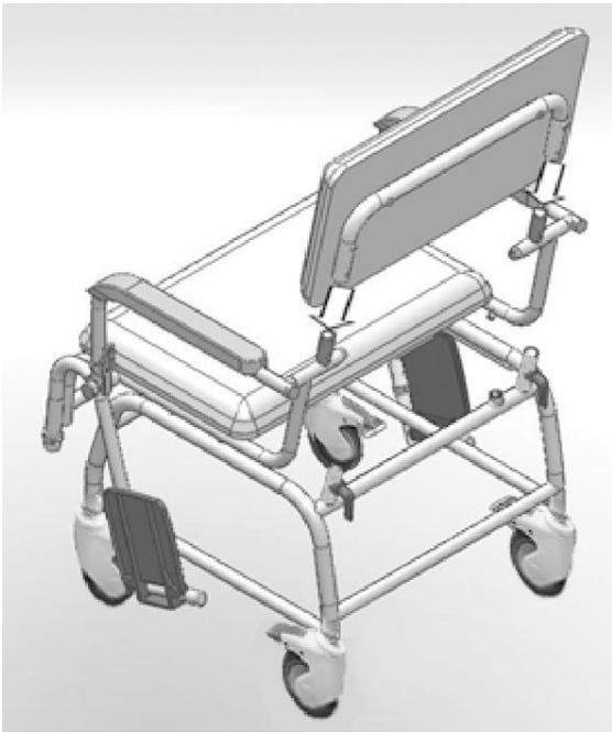
3. Stecken Sie E-Typ-Clips in das Loch, um die Rückenlehne zu sichern
