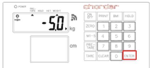
**HINWEIS :** Das Vortaragewicht muss unter der maximalen Kapazität liegen, sonst zeigt das Display nach Drücken der **[EINGABE]** -Taste 0,00 an und der Bediener muss die Vortaraeinstellungen erneut eingeben.
