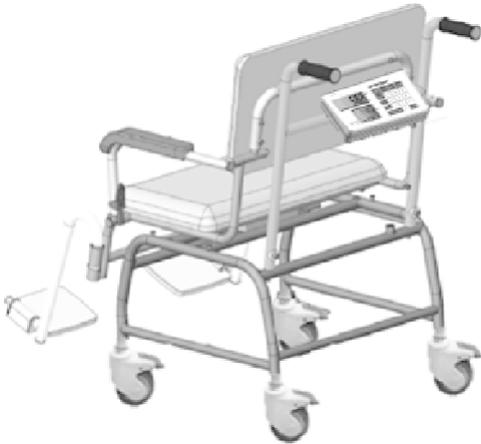
3. Die L-Griffschrauben festziehen und den Griffrahmen mit dem Geräterahmen verbinden (zum Festziehen im Uhrzeigersinn drehen).
