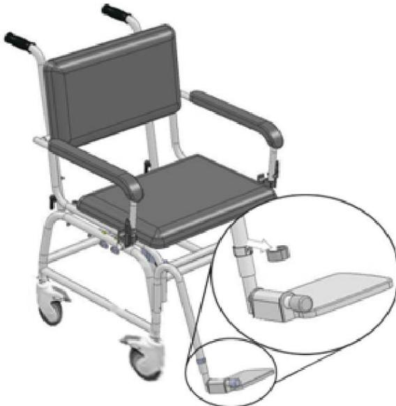
2. Passen Sie die Höhe der Fußstütze nach Bedarf an
