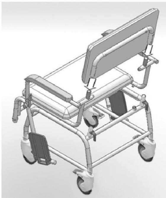
3. Insérez les clips de type E dans le trou pour fixer le dossier
