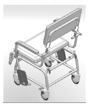
3. Inserte los clips tipo E en el orificio para asegurar el respaldo.
