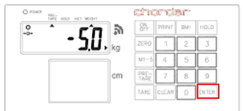
**OBSERVAÇÃO** : O peso da pré-tara deve estar abaixo da capacidade máxima, caso contrário, a tela mostrará 0,00 após a tecla **[ENTER]** ser pressionada, e o operador terá que reinserir as configurações de pré-tara.
