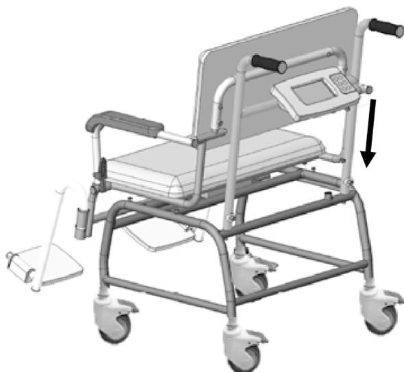
3. Serrez les vis de la poignée en L, fixant le cadre de la poignée au cadre de l'appareil (tournez dans le sens des aiguilles d'une montre pour serrer)
