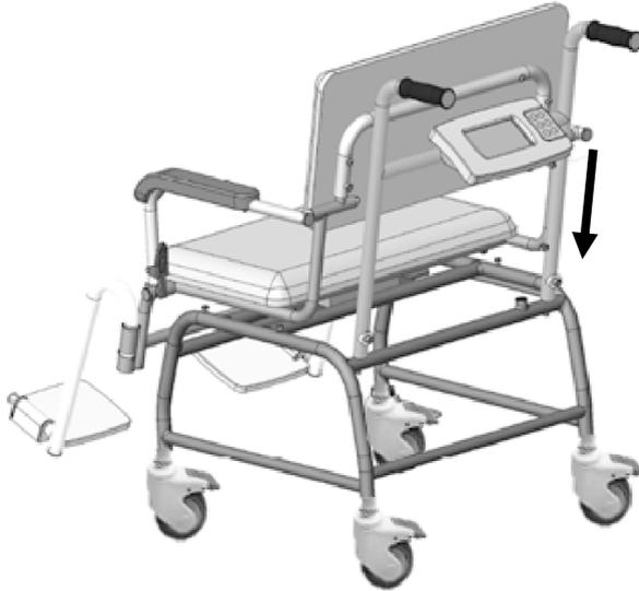
3. Fije los tornillos del mango en forma de L, asegurando el marco del mango con el marco del dispositivo (gire en el sentido de las agujas del reloj para apretar)
