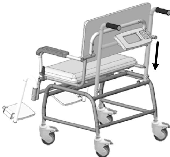
3. Aperte os parafusos da alça em L, prendendo a estrutura da alça com a estrutura do dispositivo (gire no sentido horário para apertar)
