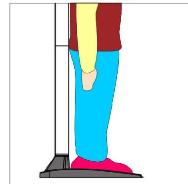
2. 請將 HM200P 支撐板輕靠牆面放置，測量時請受測者輕微碰觸到身高尺
